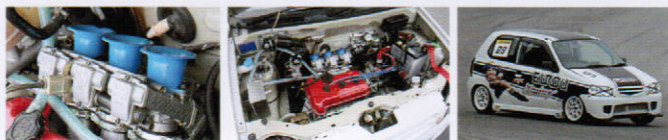
大注目のマシンがこれ! #89中井 宏一郎のEUROU Racing ALTO。ユーローの新作エアロを装着するだけでなく、エンジンには旧規格用のK6Aをフルチューン。排気量アップ3連スロットルキャブ仕様で、NAエンジンながらなんと0.05秒台を叩き出した。
