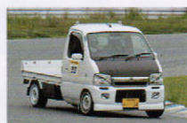
オープンクラスにエントリーして見事総合優勝を飾ったのは#98のぶのぶ輪乗選手。ファイターエンジンアリングのフルボア加工エンジンを搭載し、RHF3(A/R7)タービンをブースト1.5でブンまわしている。制動は、スズボのN1CPUにeマネージをセット。足は、アラゴスタにハイパ(コ)をおこなう本格仕様。タイヤはネオバAD0814インチ、LSDはカプチーノ用でマフラーはワンオフ。
